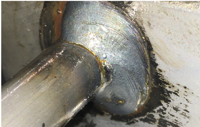
Abbildung 5: KI-basierte optische Prüfung der Schweißqualität Quelle: Weber-Hydraulik GmbH
