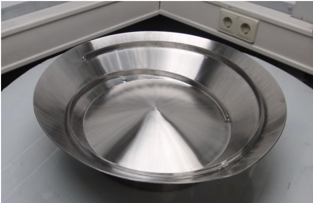
Abbildung 2: Verschleißener kegelförmiger Sortiertopf in Edelstahl mit Gang
