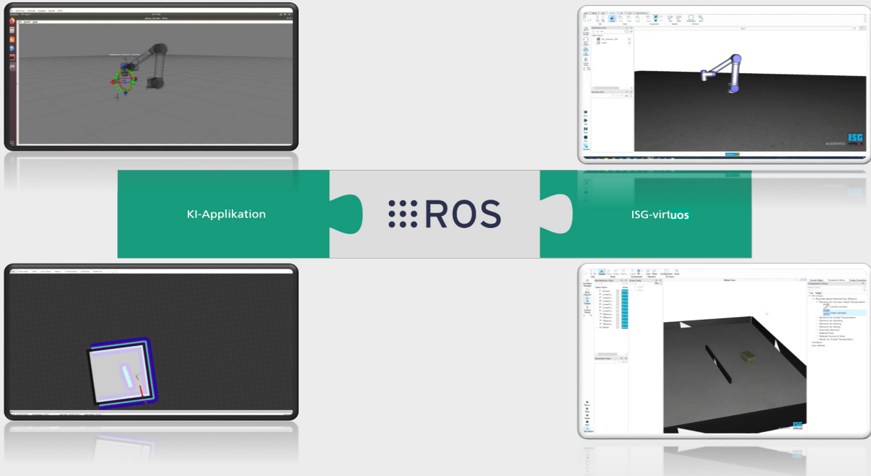
Intelligente Robotersteuerungen steuern und regeln virtuelle Roboter in der Simulationsplattform »ISG-virtuos«. Lorenz Halt, Fraunhofer IPA
