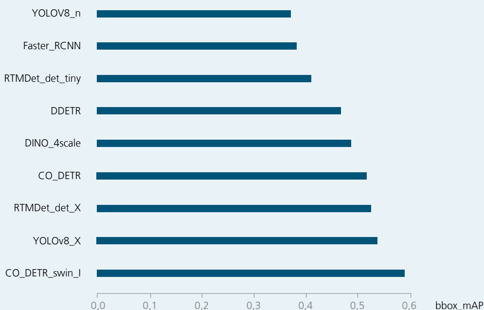
Abbildung 7: mAP gemittelt über IoU-Schwellenwerte von 0,5 bis 0,95 (mAP[0.5:0.95]) für die betrachteten 2D-Modelle. Quelle: Fraunhofer IPA.
