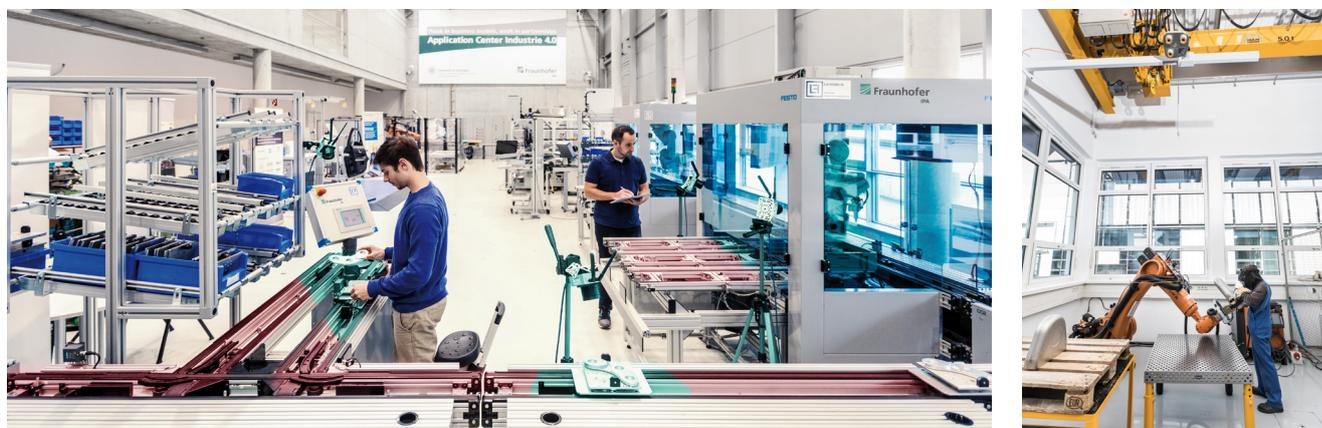
**Fig. S1.** (Links) Arbeitsplätze der Zukunft am Fraunhofer IPA. (Rechts) Ein intelligenter Sicherheitssensor (PILZ SafetyEYE ©) erkennt, ob sich ein Mensch in der Roboterzelle befindet. Bildquelle: Fraunhofer IPA, Universität Stuttgart IFF/Foto: Rainer Bez.
