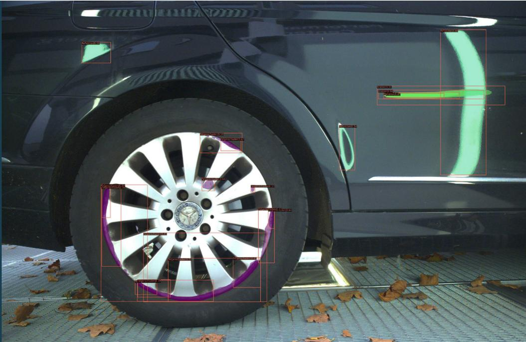
Erkannte Fahrzeugschäden und Reflexionen, Two Tronic
