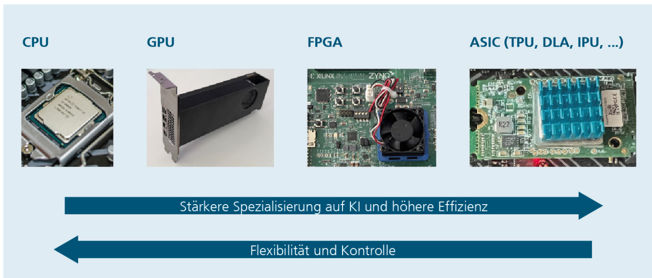
Abbildung 4: Übersicht zu Rechenarchitekturen für KI-Ausführung. Von links nach rechts: Intel Core i7 8700K, Nvidia RTX A2000, Xilinx Zynq UltraScale+ Evaluationsboard, Hailo-8 m.2-Modul mit Kühlkörper. Quellen: Alexandru Bogdan/Unsplash, Fraunhofer IPA/Foto: Timo Leitz.
