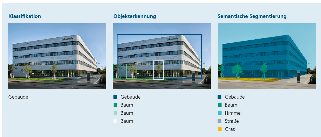
Abbildung 3: Vergleich zwischen Klassifikation, Objekterkennung und semantischer Segmentierung. Quelle: Fraunhofer IPA/Foto: Rainer Bez.
