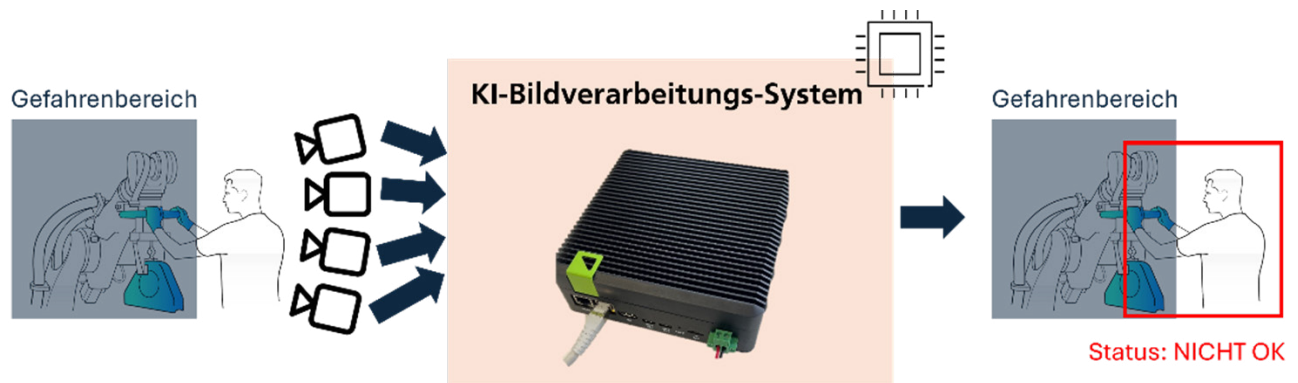
Abbildung 20: Schema des Multi-Kamerasystems mit Nvidia Jetson Hardware. Quelle: Fraunhofer IPA/Foto: Timo Leitzitz.
