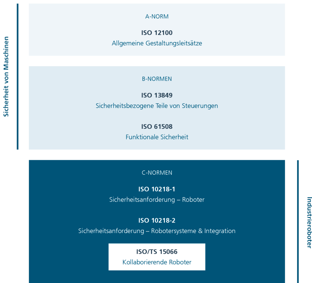
Abbildung 3: Hierarchische Struktur der Normen für MRK-Anlagen. Eigene Darstellung nach einer Grafik aus Schunk (2022): »Die Handhabung in der Mensch-Roboter-Kollaboration«: https://industrieanzeiger.industrie.de/wp-content/uploads/VIo/Vortrag_Schunk.pdf
